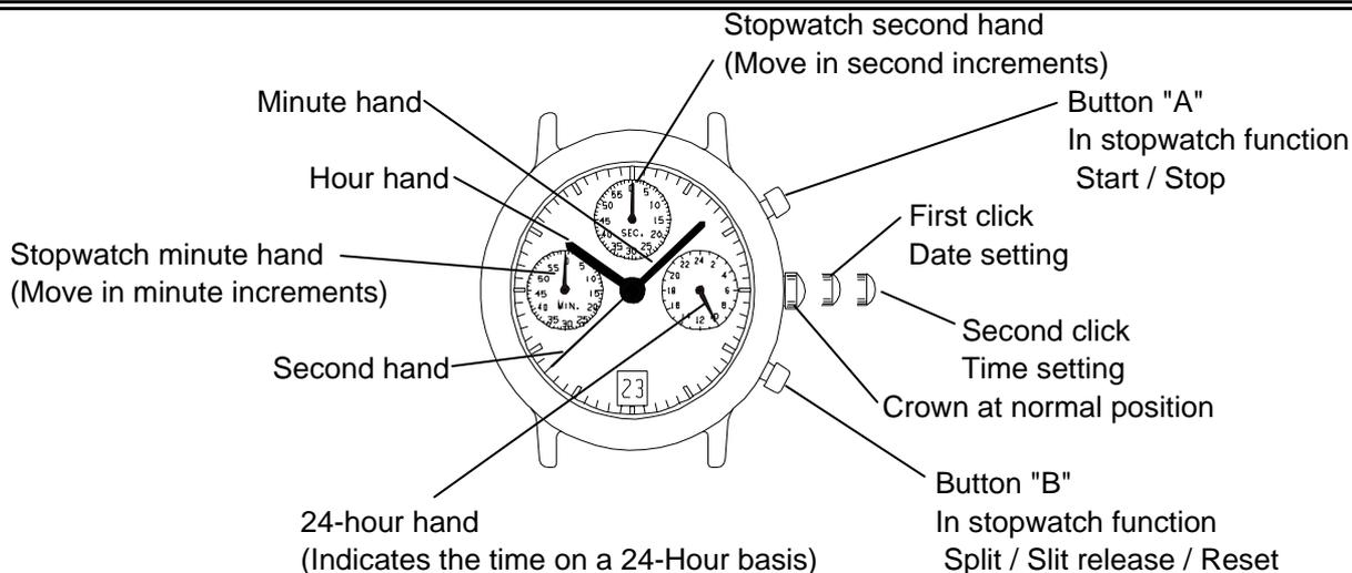
**ADJUSTING THE STOPWATCH HAND POSITION**
